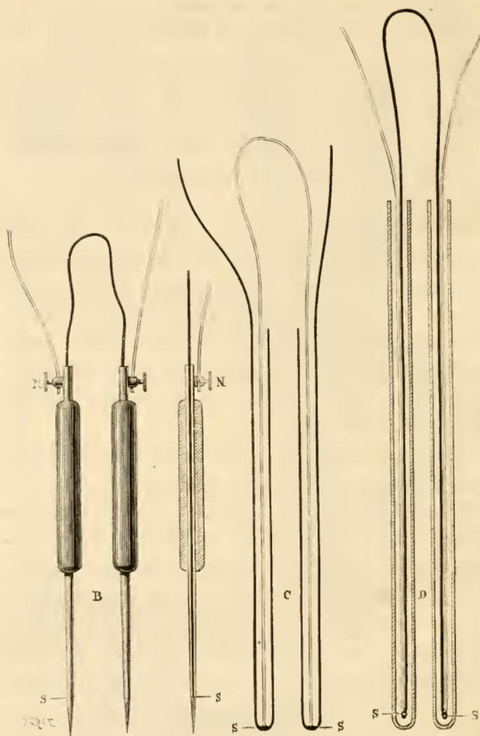
FIG. 101. — Sondes thermo-électriques de d'Arsouval.
